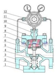
先导活塞式气体减压阀(结构图)
