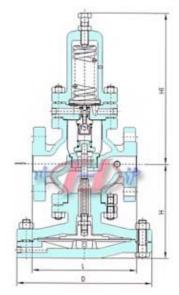
先导式高灵敏度减压阀 (结构图)
