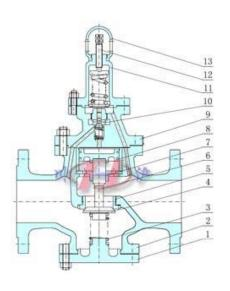
先导活塞式蒸汽减压阀(结构图)
