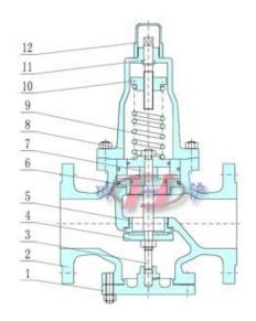
水用减压阀 空气减压阀 (结构图)
