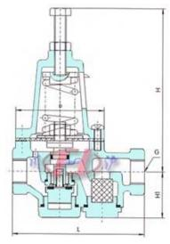
直接作用薄膜式减压阀(结构图)
