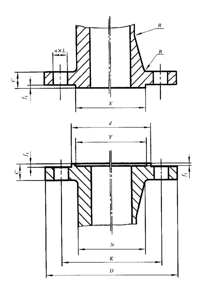
图 1 凹凸面(MF)整体钢制管法兰 (适用于 PN1. 6、PN2. 5、PN4. 0、PN6. 3、PN10. 0 和 PN16. 0MPa)
