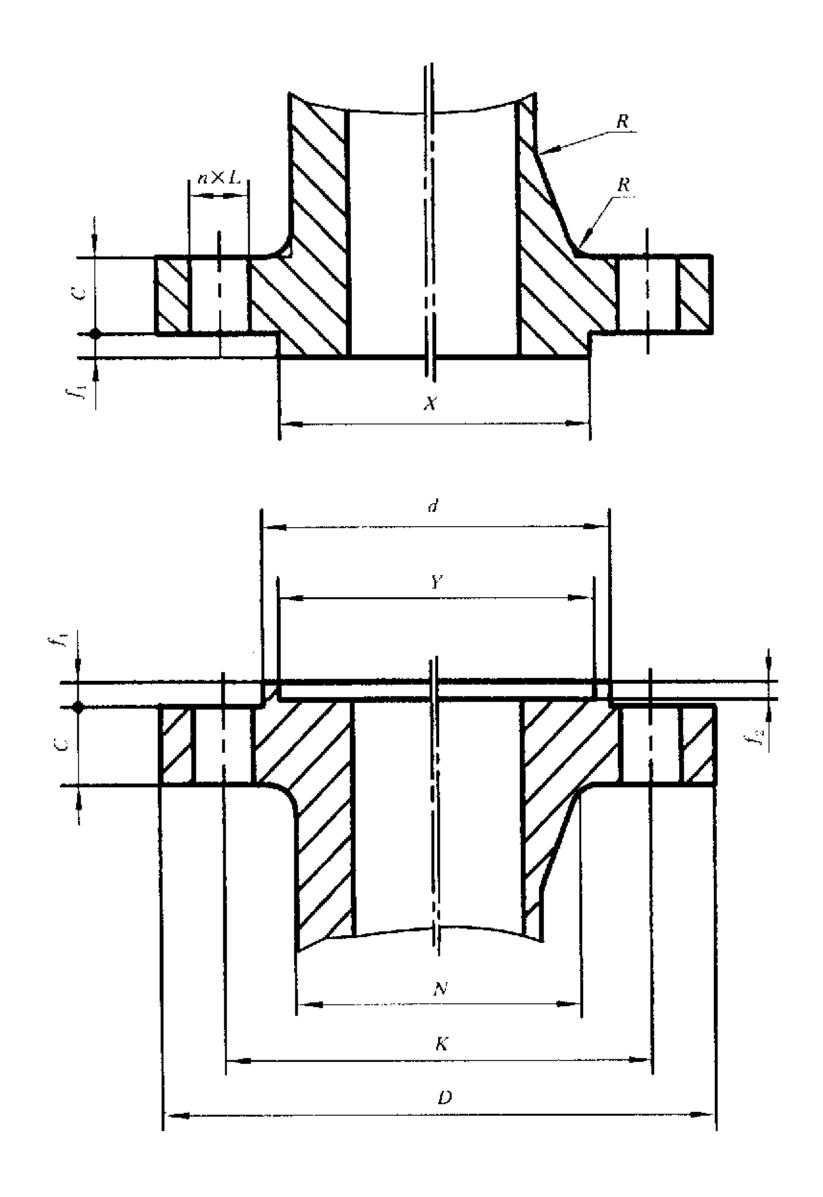
图 2 四凸面(MF)整体钢制管法兰 (适用于 PN5.0、PN11.0、PN15.0 和 PN26,0MPa)
